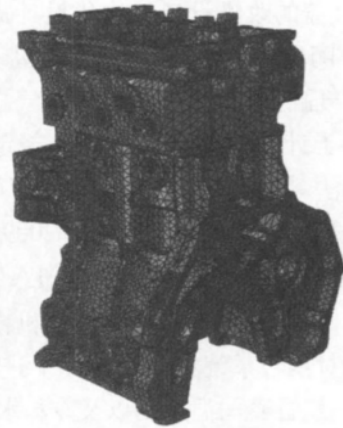
图 6 装配应力场计算网格模型
